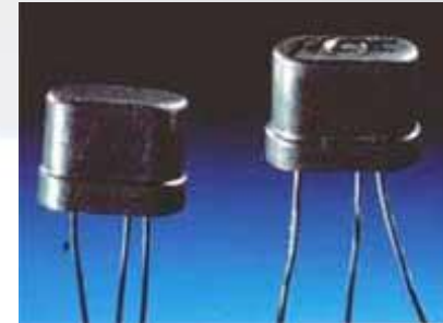
Pierwsze krzemowe tranzystory wyprodukowane przez Texas Instruments w 1954 roku
