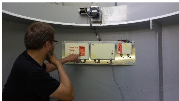
Fot. 8. Elektronika sterująca kopułą ScopeDome 2M
